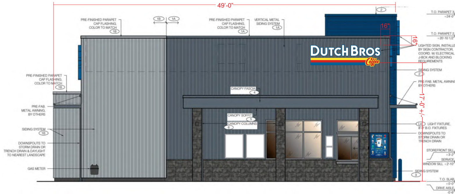
SOUTH ELEVATION SCALE: 1/8" = 1'-0"
